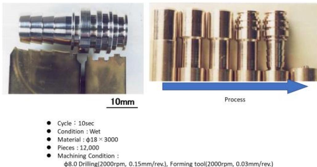
Fig.9 六軸自動旋盤での切削事例 3
