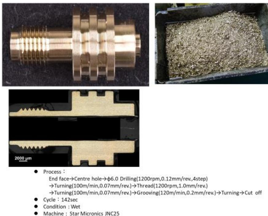
Fig.10-1 バルブ用部品の切削事例 4-1
