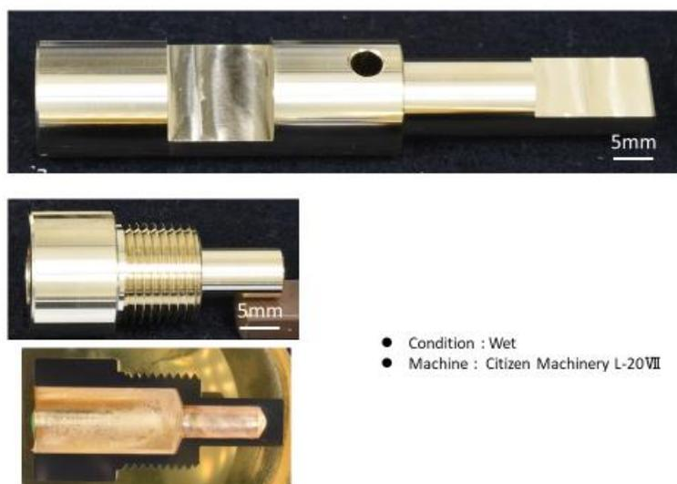
Fig.23 フライス加工を含む部品、温度センサー類似部品の切削事例 9
