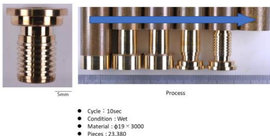
Fig. 8 六軸自動旋盤での切削事例 2
