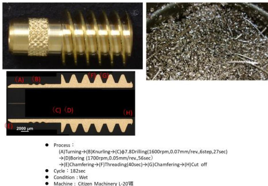
Fig.22 ウォームギア類似部品の切削事例 8
