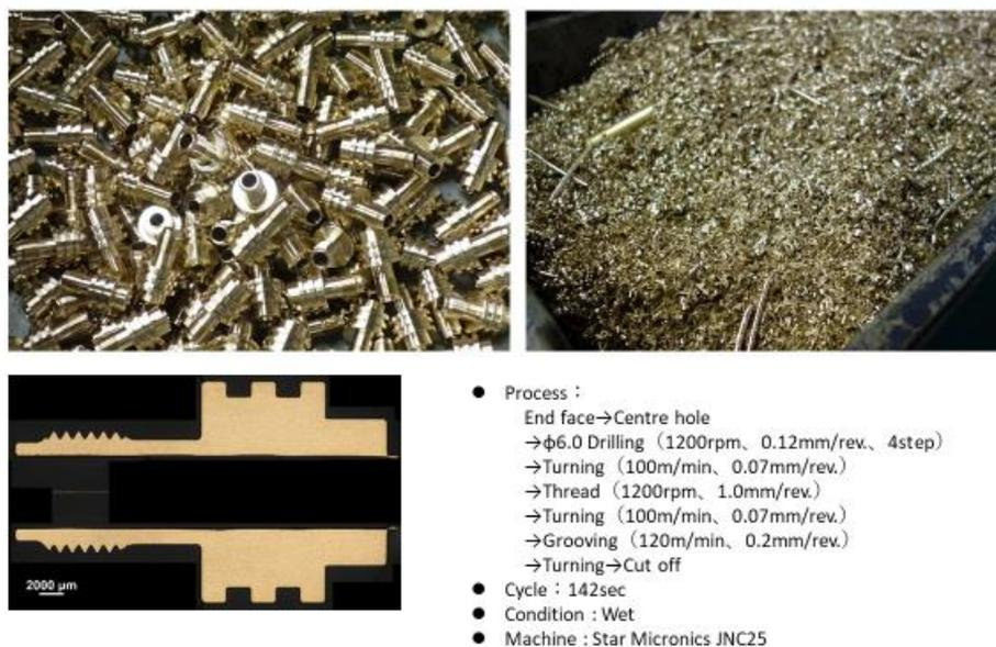
Fig.21 バルブ用部品の切削事例 7
